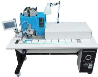
2 Máquina inyectora de cera
