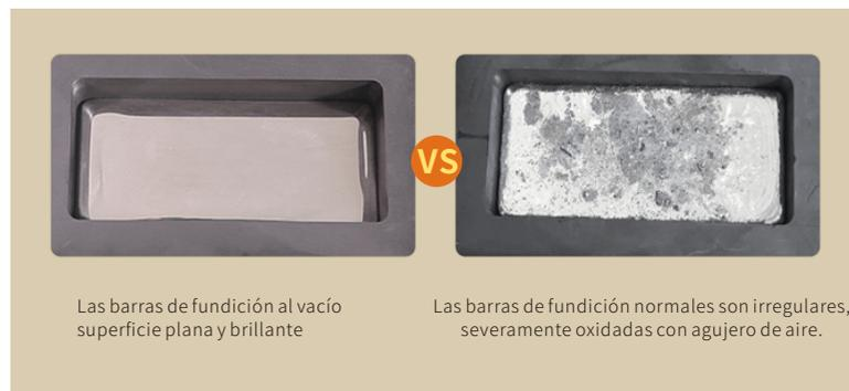
Las barras de fundición al vacío superficie plana y brillante
